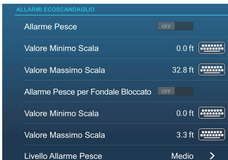
3. Impostare la profondità iniziale in [Valore Minimo Scala] e la profondità finale in [Valore Massimo Scala].
