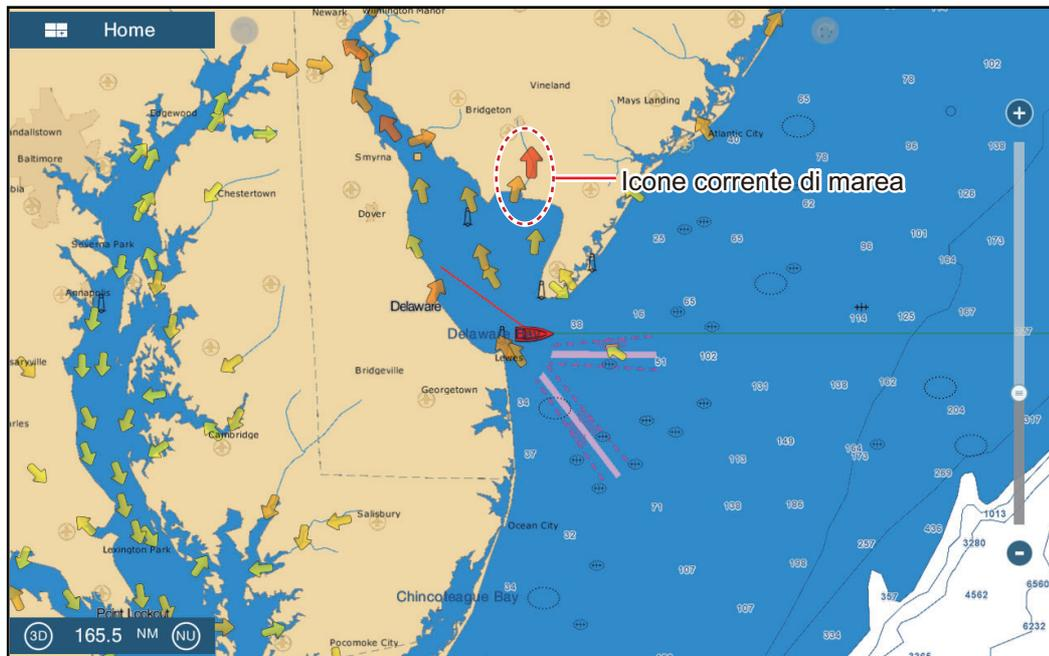
La freccia punta nella direzione del movimento della corrente di marea. La dimensione e il colore della freccia indicano la velocità della corrente di marea (giallo: lento, arancione: medio, rosso: veloce).
