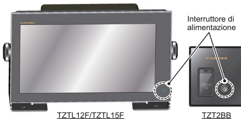
Quando si inserisce l'alimentazione, l'apparecchiatura emette un doppio segnale acustico e si apre la schermata di avvio. Una volta completato il processo di avvio, si apre la schermata [AVVISO DI NAVIGAZIONE]. Leggere l'avviso, quindi toccare [OK]. Compare l'ultima visualizzazione usata.
