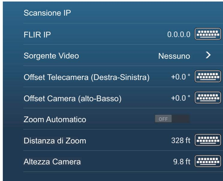
**Nota:** Per utilizzare la funzione PTZ della videocamera FLIR con NavNet TZtouch2, è necessario effettuare un'impostazione (Interfaccia Nexus CGI, porta: 8090) sulla videocamera FLIR. Per ulteriori informazioni, vedere il manuale operativo della videocamera FLIR.
