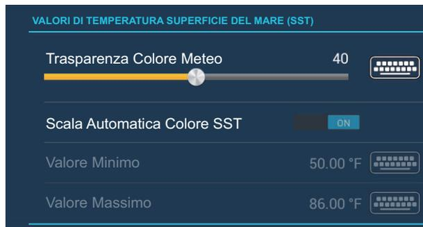
**[Trasparenza Colore Meteo]:** Regolare il grado di trasparenza per l'overlay meteo. Più alto è il numero, maggiore sarà il grado di trasparenza.
