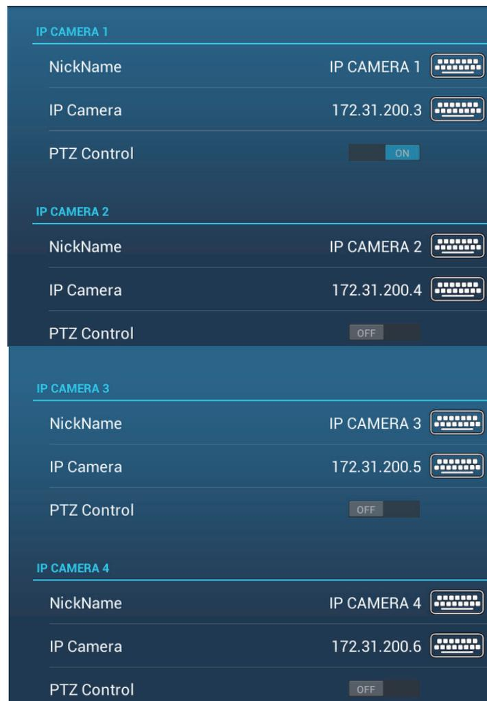
**Nickname:** Se si desidera, è possibile cambiare il nome della videocamera IP. I nomi predefiniti sono [IP CAMERA 1], [IP CAMERA 2], [IP CAMERA 3], [IP CAMERA 4]. È possibile utilizzare un massimo di 20 caratteri. Per modificare un nome, toccare [Nickname] per visualizzare la tastiera software. Modificare il nome, quindi toccare [✓] per confermare. Il nome viene visualizzato nelle seguenti posizioni.
