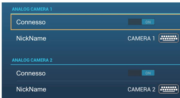
**Connesso:** Attivare per utilizzare il dispositivo (apparecchiatura video, videocamera FLIR) collegato alla porta VIDEO-IN1, VIDEO-IN2.
