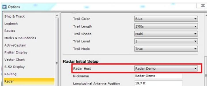
Activer la transmission du radar et sélectionnez l'option **Radar** dans les options de TIMEZERO pour ajuster les différents réglages du radar :
