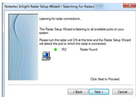
**Remarque :** si l'assistant n'arrive pas à détecter le radar (après une longue attente), mettre le radar hors tension (off) et le redémarrer la mise sous tension (à On). Vérifiez que le câble Ethernet est branché et que le trafic sur le routeur est actif (led allumée sur la face avant du routeur). Essayez aussi de désactiver le pare-feu de l'ordinateur.
